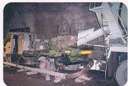
55M 3 モーター駆動&エンジン駆動両用搭載型コンクリートポンプ車
