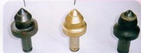
MC-3027F3PT MC-3027F KC-3427F 軟岩、中硬岩向きでビットBOXの摩耗をふせぎます。
