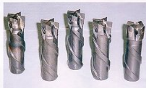
スパイラルビット 28R-45 φ 28R-45 φ (逆ブロー) 32R-45 φ 32R-50 φ 32R-45 φ ルイジ 東芝タンガロイ
