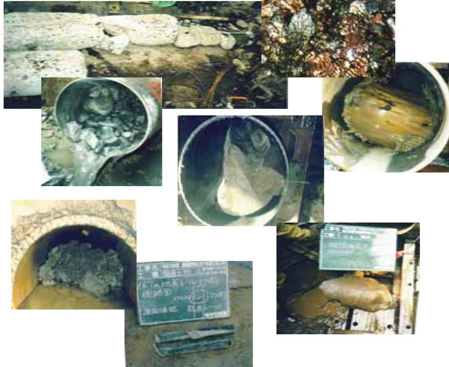
**1匹のもぐらシステム**は鋼管の刃先に埋め込まれた超合金ビット(一層盛)を正逆回転させ、地中の障害物を切断・取込ながら推進する鋼管さや管方式です。対応土質は普通土です。
